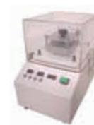
凍結破碎装置(AUTOMILL)
